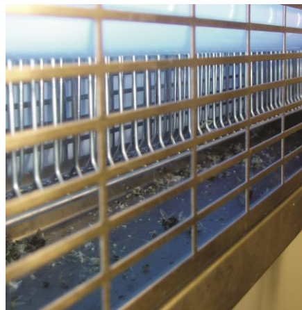
Slika 10.1. Primjer elektroničkog uređaja s UV lampom za usmrćivanje letećih insekata koji se koristi za veće prostorije (lijevo). Krupni plan elektroničkog UV uređaja za uništavanje insekata pokazuje zbog čega je redoviti pregled i čišćenje od iznimne važnosti (desno).
