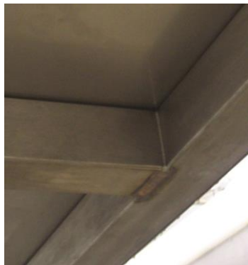
Slika 4.3. Prostor ispod stola koji prikazuje strukturu četvrtastih cijevi čiji su spojevi primjereno zavareni kako bi se prostori u kojima se prljavština i vlaga mogu nakupljati sveli na najmanju moguću mjeru.
