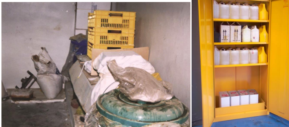
Slika 9.1. Primjer nepravilnog (lijevo) i pravilnog s jasno označenim spremnicima (desno) skladištenja kemikalija.
