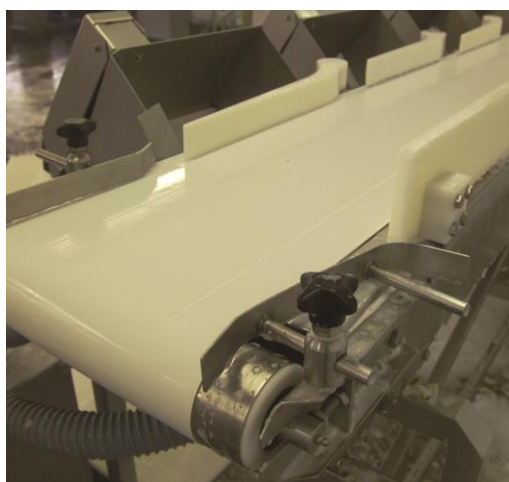
Slika 4.4. Uređaj za automatsko sortiranje (lijevo) i za ručno ukutijavanje (desno), prikazuju dizajn kojim se mjesta u kojima se otpad nastao u proizvodnji može nakupljati sve do na najmanju moguću
