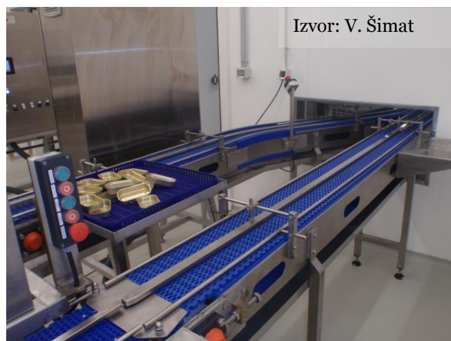
Slika 4.4. Uređaj za automatsko sortiranje (lijevo) i za ručno ukutijavanje (desno), prikazuju dizajn kojim se mjesta u kojima se otpad nastao u proizvodnji može nakupljati sve do na najmanju moguću
